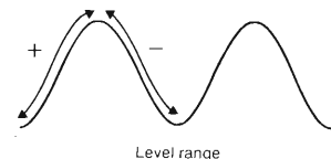
Fig. D - Selezione del livello e della pendenza del segnale di trigger: comandi sul pannello (a) e zone della forma d'onda interessate dalla selezione della pendenza positiva e negativa (b).
