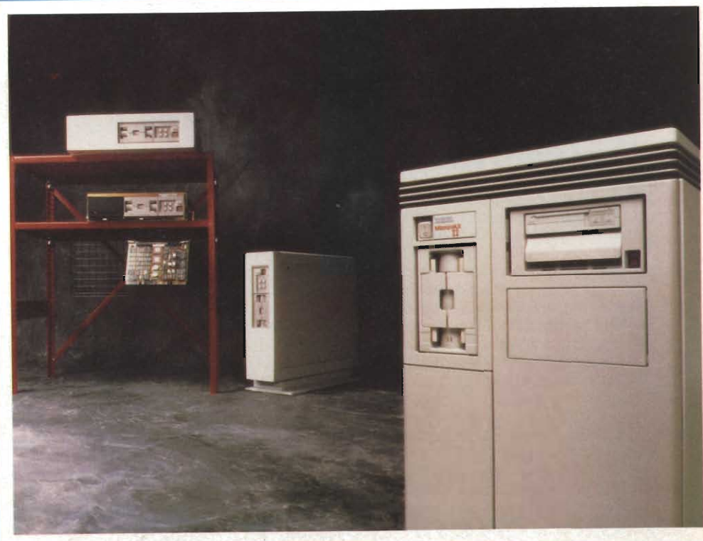
Fig. 3 - MicroVAX II è disponibile in varie configurazioni. In primo piano la configurazione (in contenitore BA123) che può contenere fino a 3 dischi Winchester da 71 Mbit per un totale di 213 Mbit, un'unità streamer da 95 Mbit oltre ad un'unità floppy duale. Il tutto può stare comodamente sotto un tavolo da lavoro. In secondo piano MicroVAX II nel contenitore BA23 per configurazioni con disco Winchester da 31 Mbit e da 71 Mbit.
